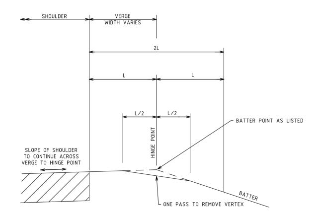
BATTER EQUAL TO OR LESS THAN 3:1
